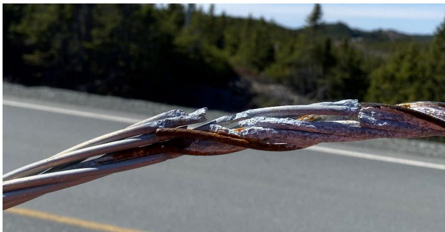
*Figure 2: 2/0 ACSR Conductor Deterioration*
